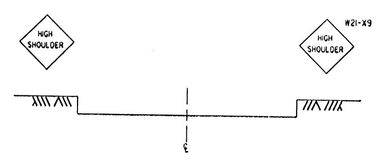
NOTE: MILLED EDGES SHOULD BE TREATED WITH TAPERS, CHANNELIZERS, AND SIGNING AS SHOWN ON EDGE DROP-OFF DETAILS.
