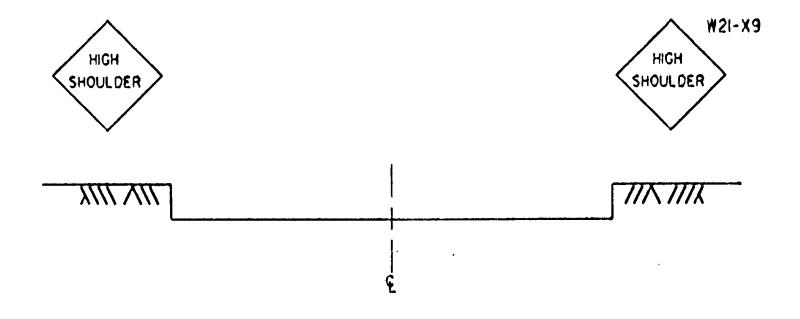
NOTE: MILLED EDGES SHOULD BE TREATED WITH TAPERS, CHANNELIZERS, AND SIGNING AS SHOWN ON EDGE DROP-OFF DETAILS.
