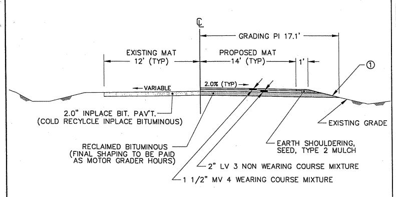
(1) STRIP INPLACE TOPSOIL PRIOR TO WIDENING, TO BE PAID AS MOTOR GRADER HOURS.
